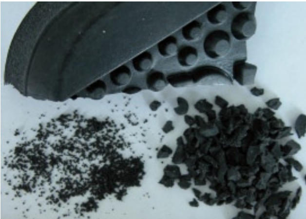
Abb. 2: Ergebnisse der Vor- und Feinzerkleinerung einer Gummischuhsohle
